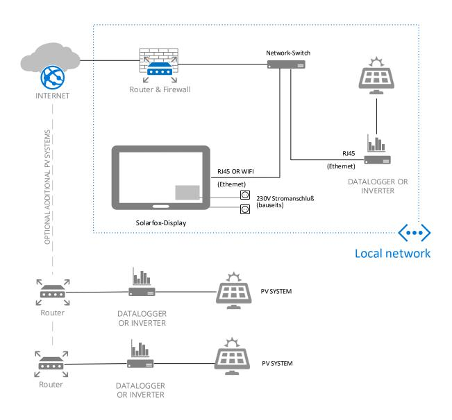
Le raccord des données à l'installation photovoltaïque s'effectue toujours par l'interface Web. De cette manière, nous sommes totalement indépendants du lieu et très flexibles. (cfr. section 5 à ce sujet)
