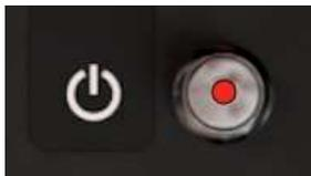
Le bouton ON / OFF est à l'état WAKE UP lorsque l'instrument est en mode timer.
