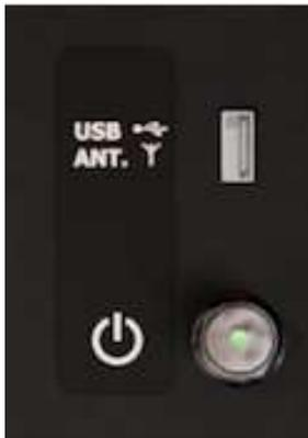
Placé au milieu du panneau avant se trouve l'interrupteur ON / OFF. Lorsque l'instrument est allumé, une petite LED dans le bouton émet une lumière verte. Le bouton ON / OFF contrôle également l'application «Minuterie». Cette application est décrite en détail dans la section Minuterie.
